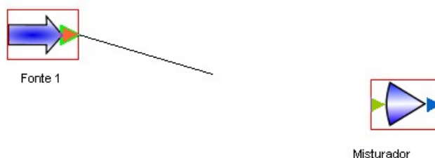
Figura 3.13: Conectando portas de equipamentos.
